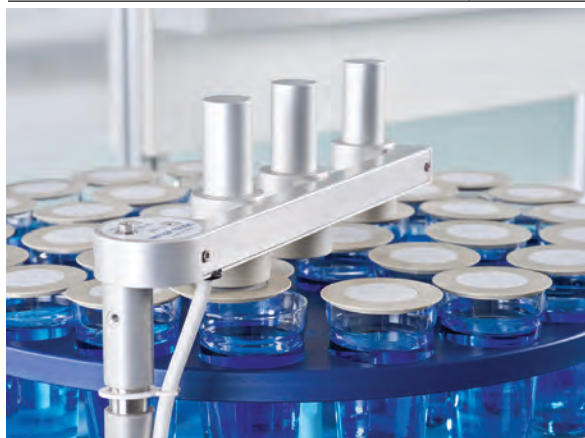
InMotion Pro 100 мл с системой открывания и закрывания крышек CoverUp™
