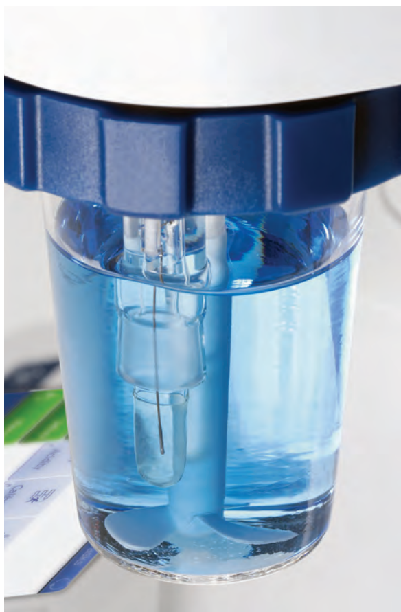
G20S с ручным стендом для титрования, рН-электродом DG1115-SC
